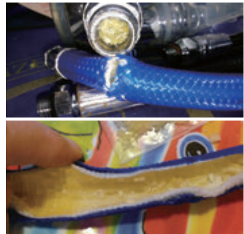
ナイロン編み上げホース内およびレギュレーター内の「多形結晶化」。レギュレーターの写真はCozumel SCUBA Repair社提供。撮影者の許可を得て掲載
